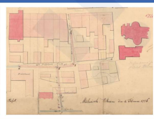
Patrně první návrh uliční kanalizace v trase dnešních ulic Střelnická a Pivovarská, s odvedením nečistot do vodního příkopu (1856), který nebyl realizován z důvodu velké finanční náročnosti. Na levé straně příčný profil projektované kanalizační stoky (1856).
